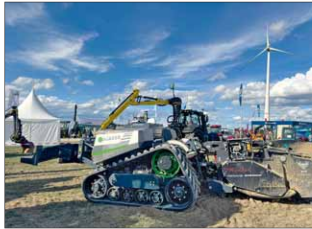
Im Bereich Robotik wurde eine Raupe von Agxeed mit angebauter Streifenfräse gezeigt.
