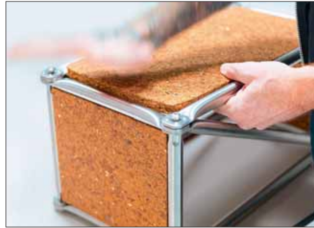
Neues aus 100 % Recyclingmaterial: Recyclingspanplatten werden zu einem Demonstrationsmöbel montiert.
