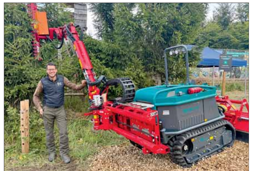
Für den „Moritz“ von Pfanzelt gibt es als neue Anbaugeräte eine Astschere am 4,5-m-Ausleger von Dücker sowie einen Mulcher des selben Herstellers. Laut Peter Voderholzer ist das am häufigsten geordnete Anbaugerät für die kleine Raupe jedoch die Fräse.
